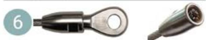
6 Pour contrôle du bon montage, retirer à nouveau la tête, et s'assurer que les brins du câble sont correctement répartis autour du cône et qu'ils sont bien positionnés dans la forme conique de la tête, comme sur la photo. L'olive ne doit pas avoir glissé (voir 4). Pour finir, re-visser les pièces ensemble et laisser la colle sécher.
