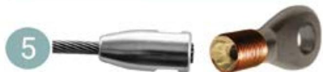
5 Enduisez les surfaces de cette pièce en contact avec le câble de lubrifiant Blue Wave. La terminaison SCT est maintenant prête à être assemblée. Utilisez les outils appropriés pour visser les pièces ensemble. Une fois vissée (jusqu'au point d'apparition de résistance), bloquer par un demi-tour supplémentaire. Note : La partie supérieure de l'embout (la tête) ne doit pas laisser apparaître plus de 2 ou 3 filets.
