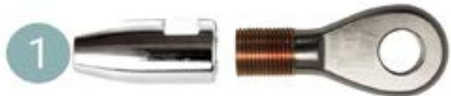
1 Appliquer Loctite 262 (ou équivalent) sur les filets, et visser les deux parties ensemble. Séparez à nouveau les deux pièces afin de vous assurer que les filets sont correctement enduits de Loctite.
